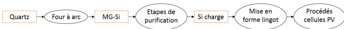
Figure I-1: Etapes d'élaboration de cellules PV à base de silicium, à partir du minerai de quartz
