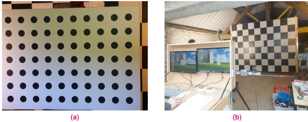
FIGURE 3.7 – (a) Photographie de la mire Zhang, acquise durant la procédure de calibrage. La mire est adaptée pour qu'elle soit manipulée par une personne. (b) Image du processus de calibrage suivant la méthode de Tsai. Les dimensions de la mire ( 3,05 \times 2,44\text{m} ) font que la distance entre les caméras et la cible est sensiblement la même que lors des acquisitions dans le tunnel.
