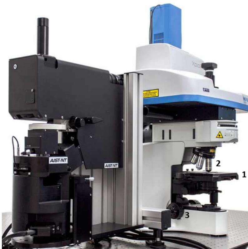
Figure 49. Spectromètre XploRA<sup>MD</sup> (Horiba Jobin-Yvon, Japon) (ISM, UMR 5255 CNRS). 1 : table motorisée (XY), 2 : objectif, 3 : molette de réglage des Z.
