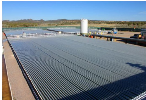
Figure I-12 : Photographies de différentes installations de PBR tubulaires. A gauche : PBR hélicoïdal, vertical Murdoch University, Australie (Chisti, 2007). A droite : PBR tubulaire horizontal immergé dans l'eau, Solix's Lumian™ Algae Growth System
