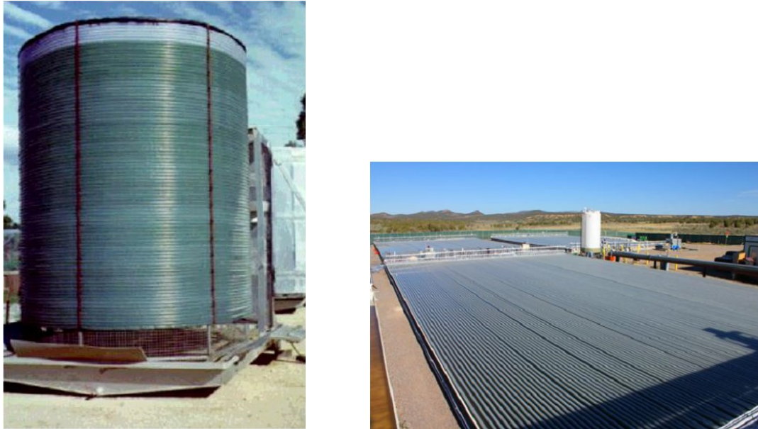
Figure I-12 : Photographies de différentes installations de PBR tubulaires. A gauche : PBR hélicoïdal, vertical Murdoch University, Australie (Chisti, 2007). A droite : PBR tubulaire horizontal immergé dans l'eau, Solix's Lumian™ Algae Growth System
