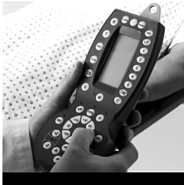
Figure 1.8 – Pupitre de commande (TeachPendant) utilisé par le praticien pour déplacer manuellement le robot lors du pré-positionnement. Le TeachPendant contient deux boutons par axe cartésien de déplacement (un par sens).
