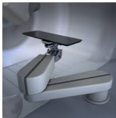
(e) Robot sériel basé sur Kuka construit par Forte Automation
