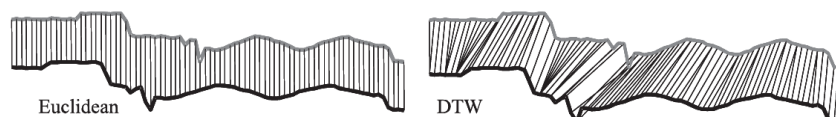
Figure 5.37 – Représentation de l’indice DTW comparé à une distance Euclidienne. Le DTW essaie de comparer les échantillons pour des ensembles de données non synchronisés.
