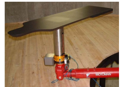
(f) Robot de traitements allongés du centre iThemba LABS (USA)
