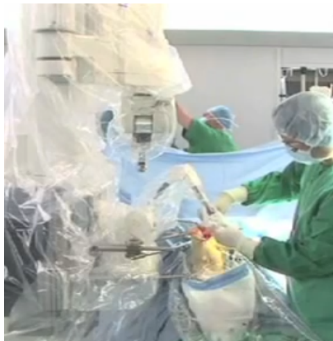
Figure 3.10 – Chirurgien utilisant une version récente du robot ROBODOC pour la mise en place d'une prothèse de genou.
