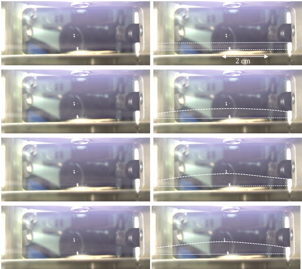
Figure 5.3 - Série d'images illustrant la perturbation d'un nuage de particules de mélamine formaldéhyde par un tir laser.
