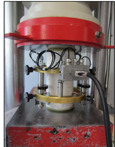
Figure 2-33 : Dispositif de mesure du module d'élasticité
