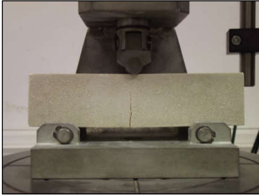
Figure 2-35 : Essai de flexion 3 points sur mortier
