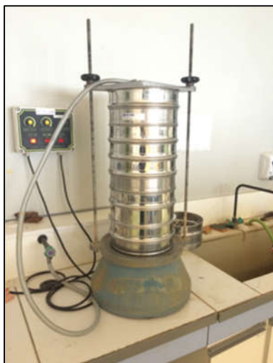
Figure 2-4 : Tamisage mécanique des granulats (NF EN 933-1)
