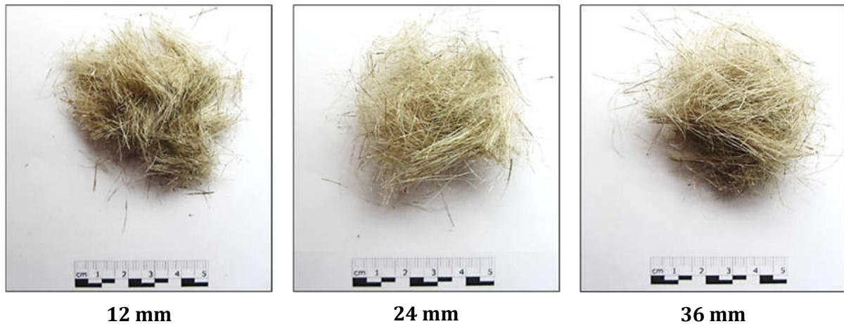
Figure 2-9 : Photographies des fibres de lin utilisées sous trois différentes longueurs
