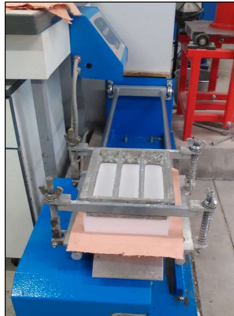
Figure 2-20 : Table à chocs normalisée (NF EN 196-1)
