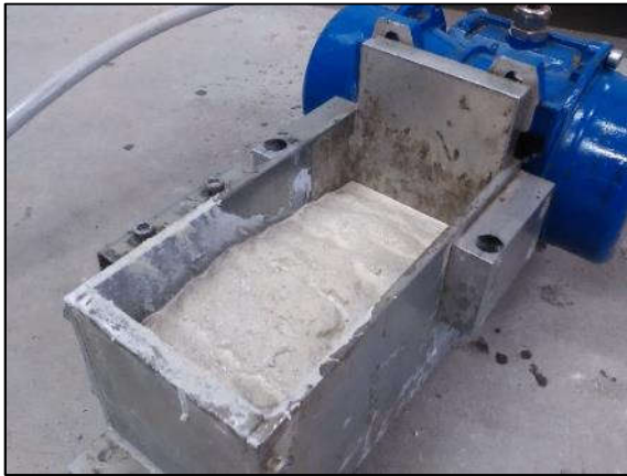
Figure 2-24 : Essai au maniabilimètre à mortier
