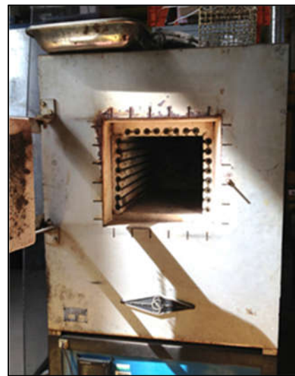
Figure 5-23 : Four utilisé pour le chauffage des bétons
