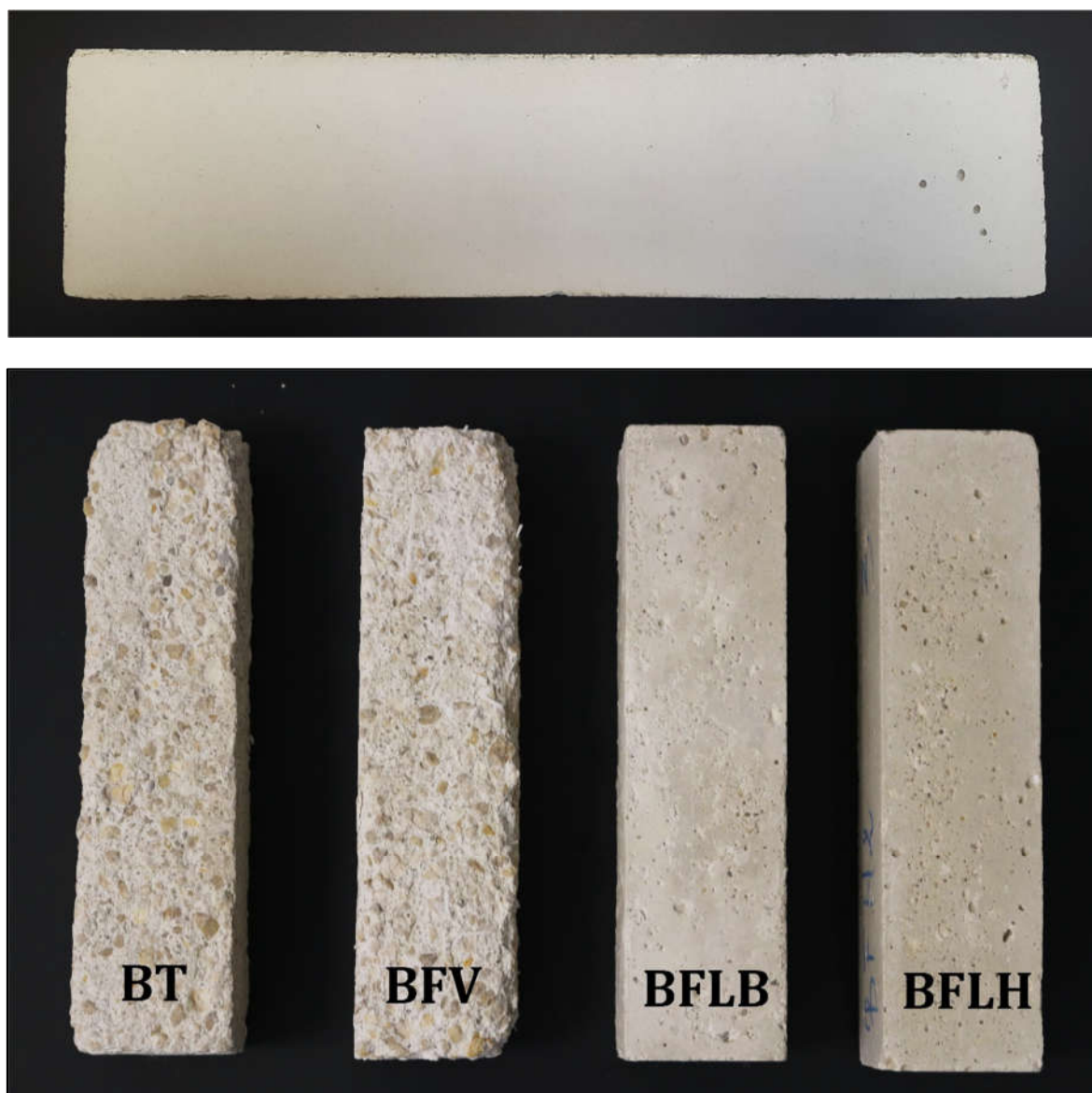
Figure 5-16 : Photographies des éprouvettes des bétons avant les essais au gel (photo du haut) et après les 300 cycles de gel-dégel (photo du bas)
