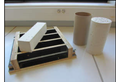
Figure 2-23 : Coffrages cylindres Ø11×22 cm et primes 7×7×28 cm
