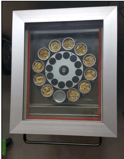
Figure 2-12 : Appareil utilisé pour les essais DVS (ProUmid)
