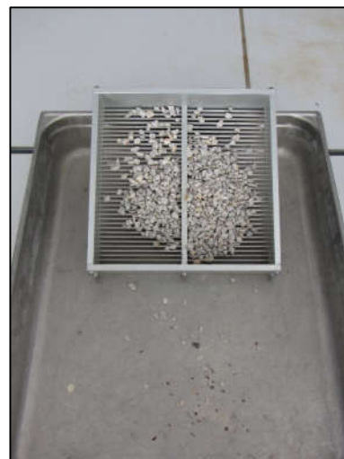
Figure 2-6 : Détermination du coefficient d'aplatissement du gravier (NF EN 933-3)
