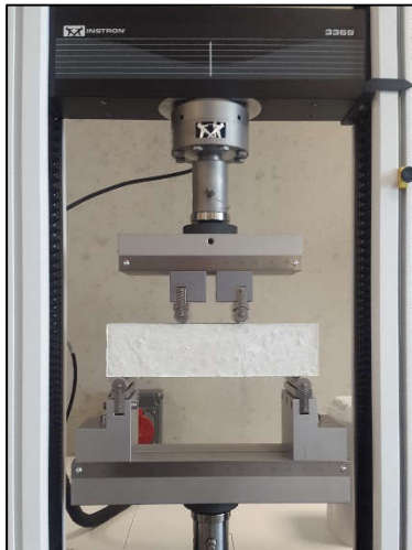
Figure 2-31 : Essai de flexion 4 points
