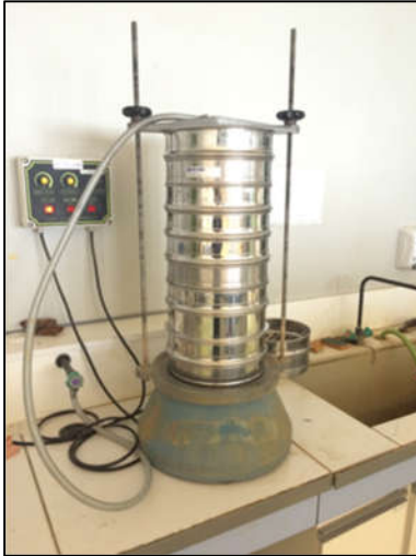
Figure 2-4 : Tamisage mécanique des granulats (NF EN 933-1)
