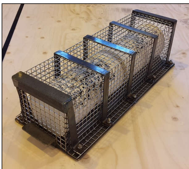
Figure 5-22 : Cage de protection des éprouvettes en cas d'éclatement
