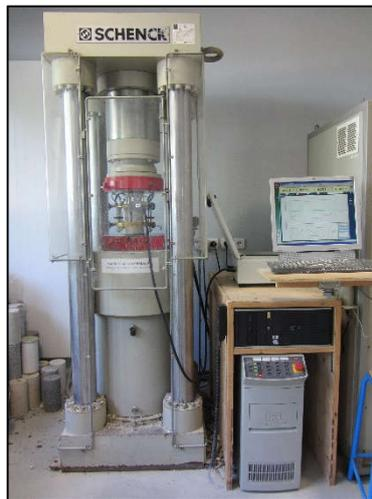
Figure 2-32 : Essai de compression simple
