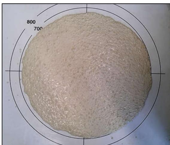
Figure 3-5 : Etallement au cône d'Abrams du béton témoin
