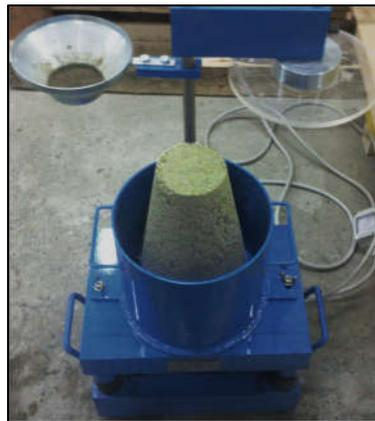
Figure 2-27 : Essai Vébé
