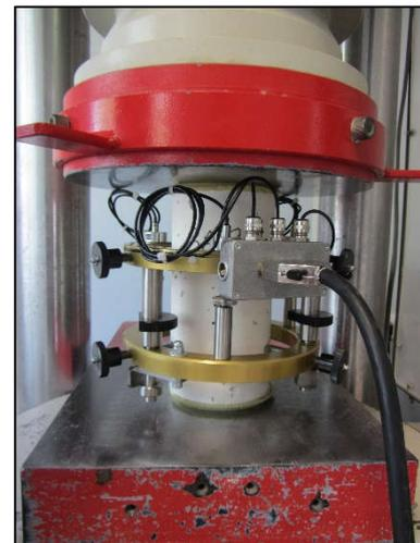
Figure 2-33 : Dispositif de mesure du module d'élasticité
