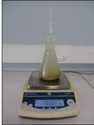
Figure 2-5 : Mesure de la masse volumique des granulats à l'aide d'un pycnomètre (EN 1097-6)
