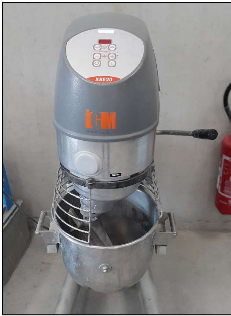
Figure 2-19 : Malaxeur IGM utilisé pour la confection des mortiers
