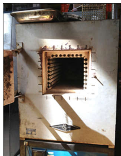
Figure 5-23 : Four utilisé pour le chauffage des bétons
