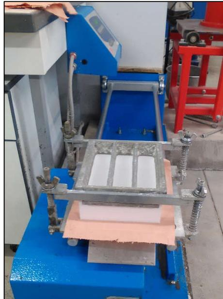
Figure 2-20 : Table à chocs normalisée (NF EN 196-1)
