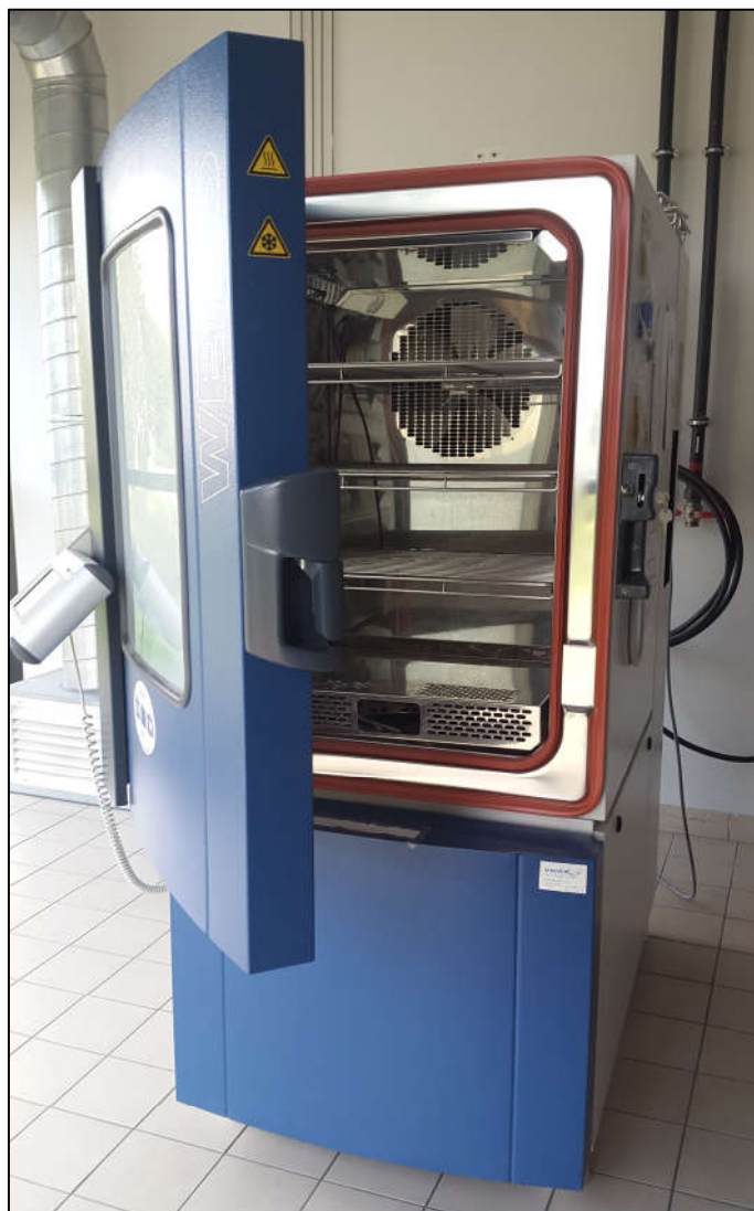
Figure 5-11 : Enceinte climatique WEISS Technik
