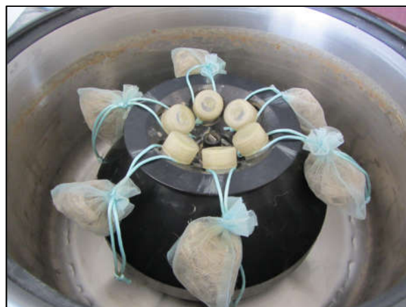
Figure 2-11 : Mise en place des sachets de fibres dans la centrifugeuse
