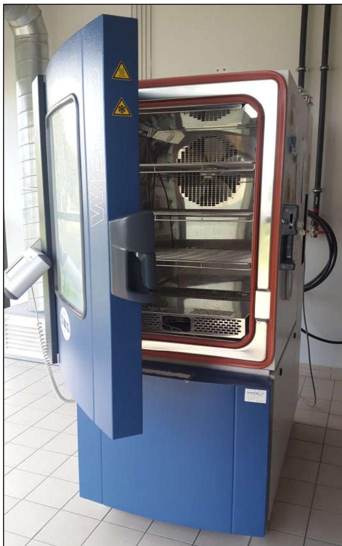
Figure 5-11 : Enceinte climatique WEISS Technik
