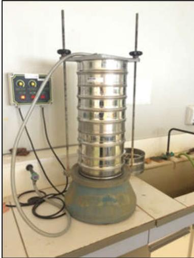
Figure 2-4 : Tamisage mécanique des granulats (NF EN 933-1)
