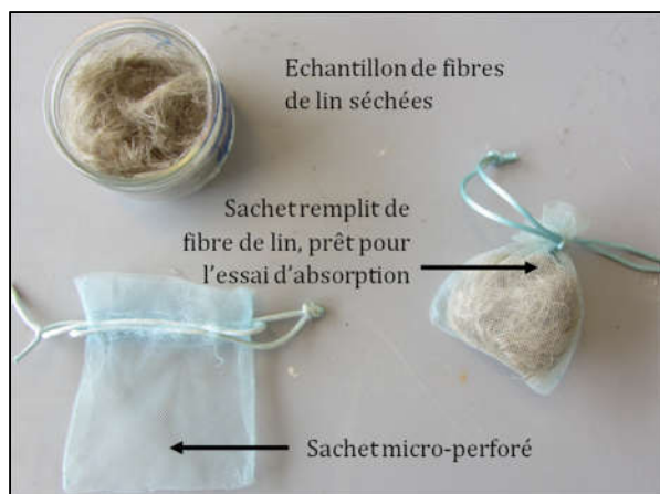
Figure 2-10 : Préparation des sachets de fibres de lin pour l'essai d'absorption d'eau
