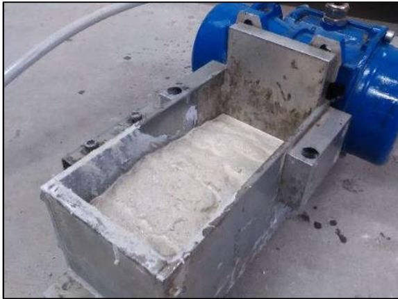
Figure 2-24 : Essai au maniabilimètre à mortier
