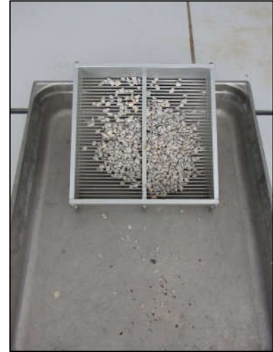
Figure 2-6 : Détermination du coefficient d'aplatissement du gravier (NF EN 933-3)
