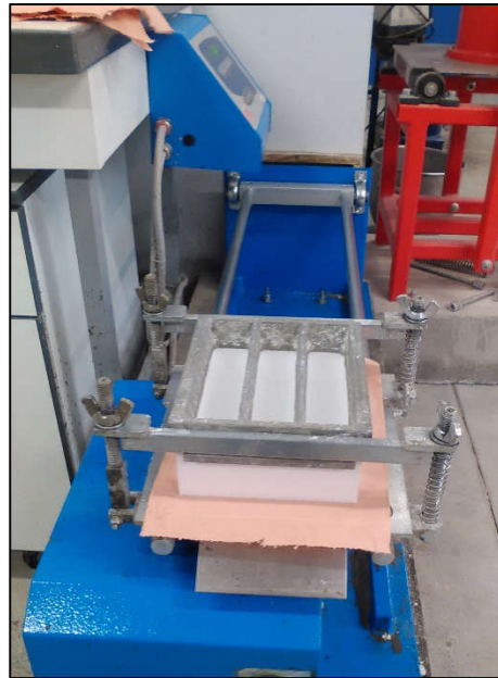
Figure 2-20 : Table à chocs normalisée (NF EN 196-1)
