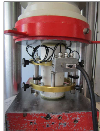
Figure 2-33 : Dispositif de mesure du module d'élasticité
