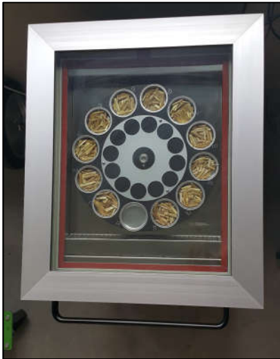
Figure 2-12 : Appareil utilisé pour les essais DVS (ProUmid)
