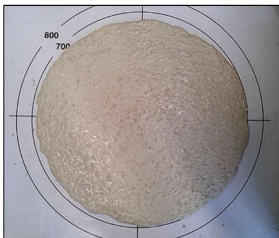
Figure 3-5 : Etallement au cône d'Abrams du béton témoin
