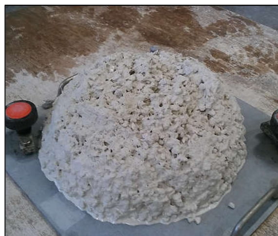
Figure 3-6 : Affaissement au cône d'Abrams pour le BFL (0,3 % - 12 mm)
