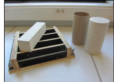
Figure 2-23 : Coffrages cylindres Ø11×22 cm et primes 7×7×28 cm
