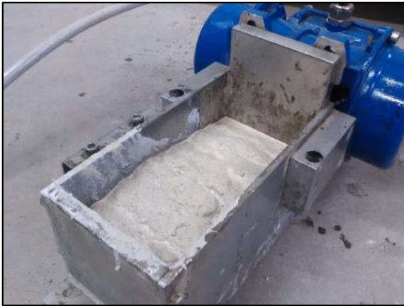
Figure 2-24 : Essai au maniabilimètre à mortier
