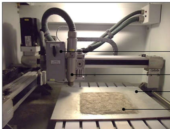
Figure 4-2 : Zone de traitement du Plasmatreater AS400
