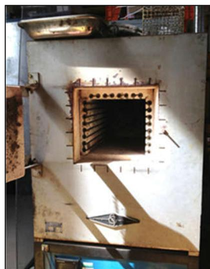
Figure 5-23 : Four utilisé pour le chauffage des bétons
