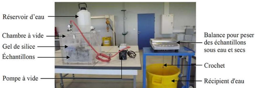
Figure 2-30 : Dispositif de mesure de la porosité accessible à l'eau
