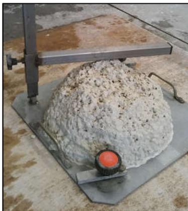
Figure 2-26 : Essai d'affaissement
