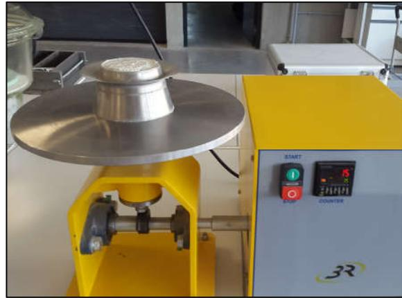
Figure 2-25 : Essai à la table à chocs
