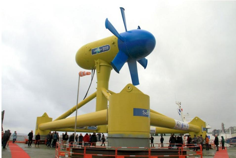
FIGURE 0.7 – Hydrolienne Sabella D10 installé dans le passage du Fromveur. Source : [www.sabella.fr](http://www.sabella.fr).
