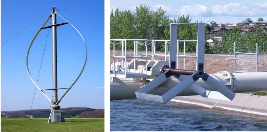
FIGURE 0.4 – Éolienne du laboratoire Sandia (gauche) et hydrolienne (en position de maintenance) de la société Instream Energy Systems (droite) à axe vertical. Sources : [www.energy.sandia.gov](http://www.energy.sandia.gov) et [www.instreamenergy.com](http://www.instreamenergy.com).
