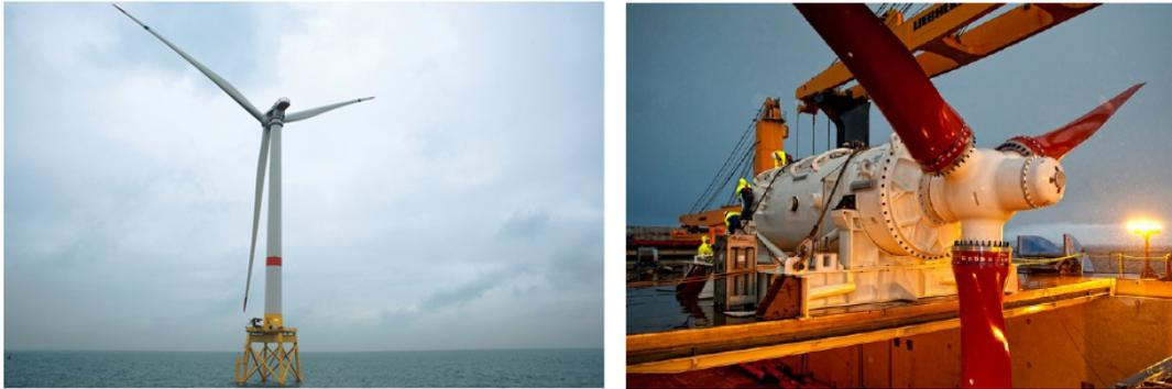
FIGURE 0.3 – Éolienne Haliade 150 d’Alstom (gauche) et hydrolienne HS 1000 d’Hammerfest Ström (droite). Les deux systèmes de récupération d’énergie sont à axe horizontal.
