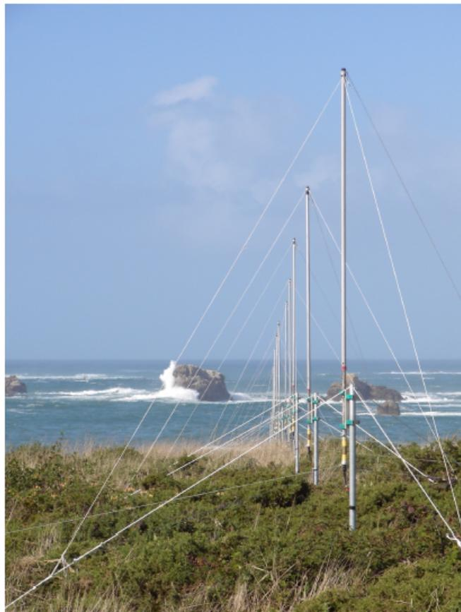
FIGURE 2.2 – Réseau de réception de 16 antennes installé au cap Garchine. Source : [www.actimar.fr](http://www.actimar.fr).
