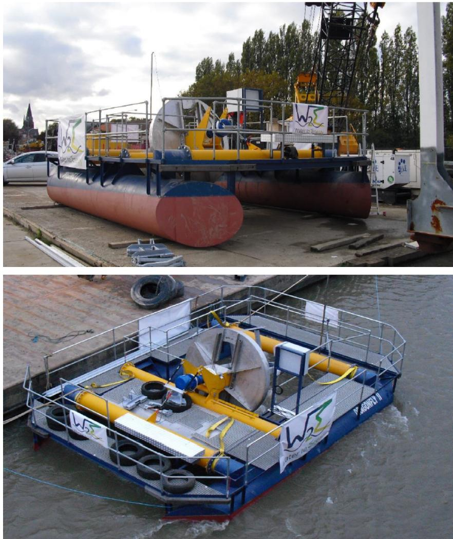
FIGURE 4.13 – Vue latérale du flotteur « Dragonfly II » (haut) et dispositif complet (flotteur + turbine) installé le long du ponton (bas). Source : [www.water2energy.nl](http://www.water2energy.nl)
