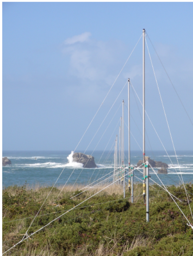
FIGURE 2.2 – Réseau de réception de 16 antennes installé au cap Garchine. Source : www.actimar.fr .
