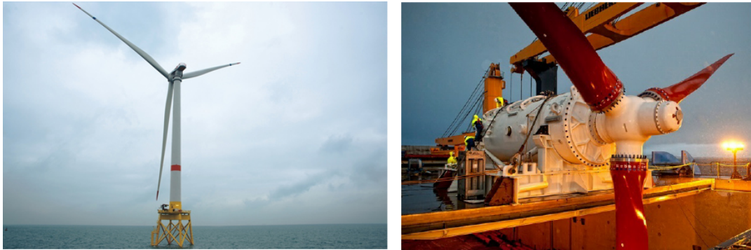
FIGURE 0.3 – Éolienne Haliade 150 d’Alstom (gauche) et hydrolienne HS 1000 d’Hammerfest Ström (droite). Les deux systèmes de récupération d’énergie sont à axe horizontal. Sources : www.alstom.com et www.hammerfeststrom.com .
