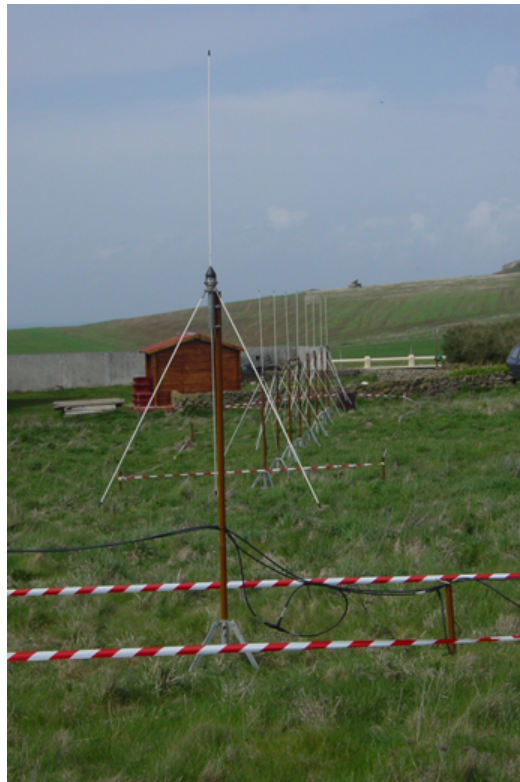
FIGURE 2.25 – Réseau de réception de 8 antennes, installé au cap Griz-Nez en avril-mai 2003.
