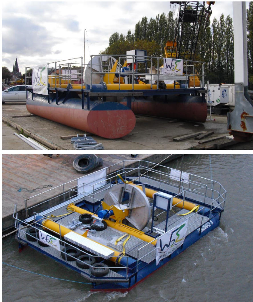
FIGURE 4.13 – Vue latérale du flotteur « Dragonfly II » (haut) et dispositif complet (flotteur + turbine) installé le long du ponton (bas). Source : www.water2energy.nl
