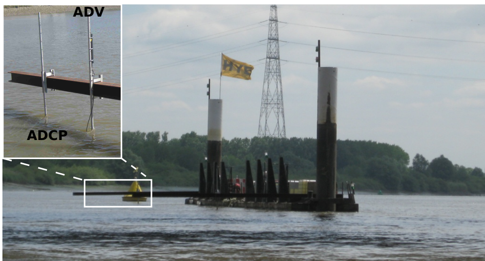
FIGURE 4.11 – ADV et ADCP, installés sur un rail métallique à l'extrémité du ponton.
