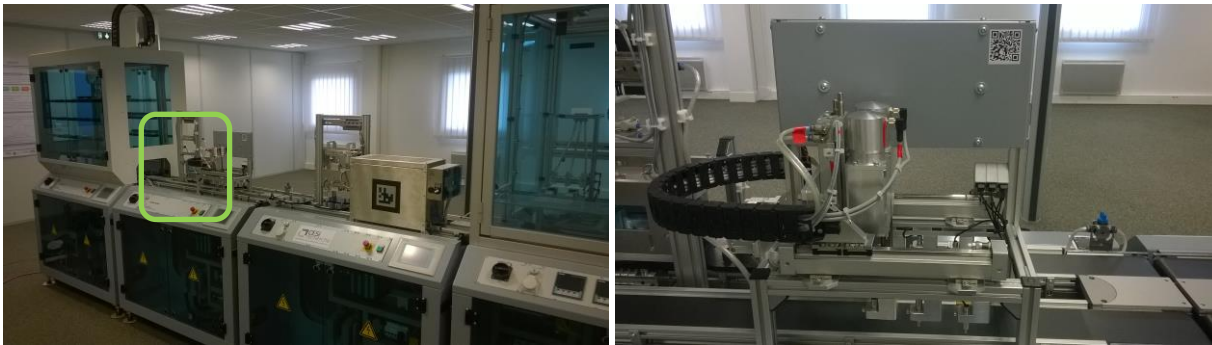
Figure 68: chaîne de production didactique sur laquelle l'opération de maintenance est effectuée. Le module de perçage est encadré en vert (à gauche). Vue zoomée du module de perçage (à droite)
