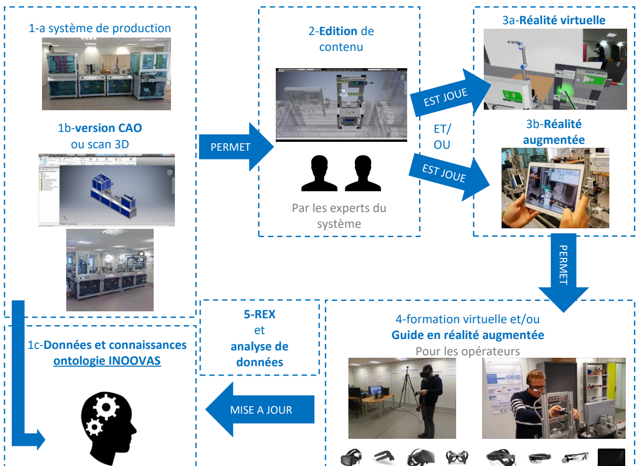
Figure 119: représentation du flux de travail permettant la création et l'édition de guides en réalité virtuelle et augmentée pour des opérations sur des systèmes industriels.
