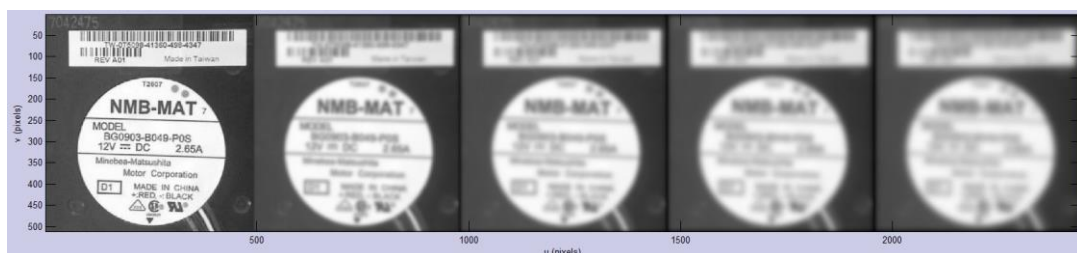
Figure 11: exemple de l'image à différentes échelles (scale). L'image de base est convoluée par un filtre gaussien de sigma=4, puis l'image résultante est convoluée avec le même filtre gaussien... etc. Images réalisées sous Matlab avec la Computer Toolbox.
