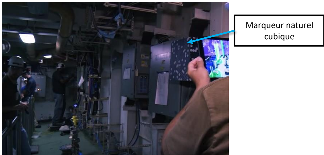
Figure 14: exemple industriel d'usage de la réalité augmentée avec un marqueur naturel (Index AR solutions voir https://youtu.be/oBzIKZqEGwI?t=1m32s ).
