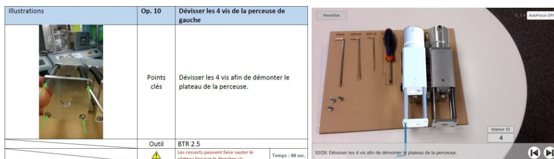
Figure 88: illustration de l'étape « Op. 10 Dévisser les 4 vis de la perceuse de gauche » pour le support tablette PDF (à gauche) et tablette RA (à droite)
