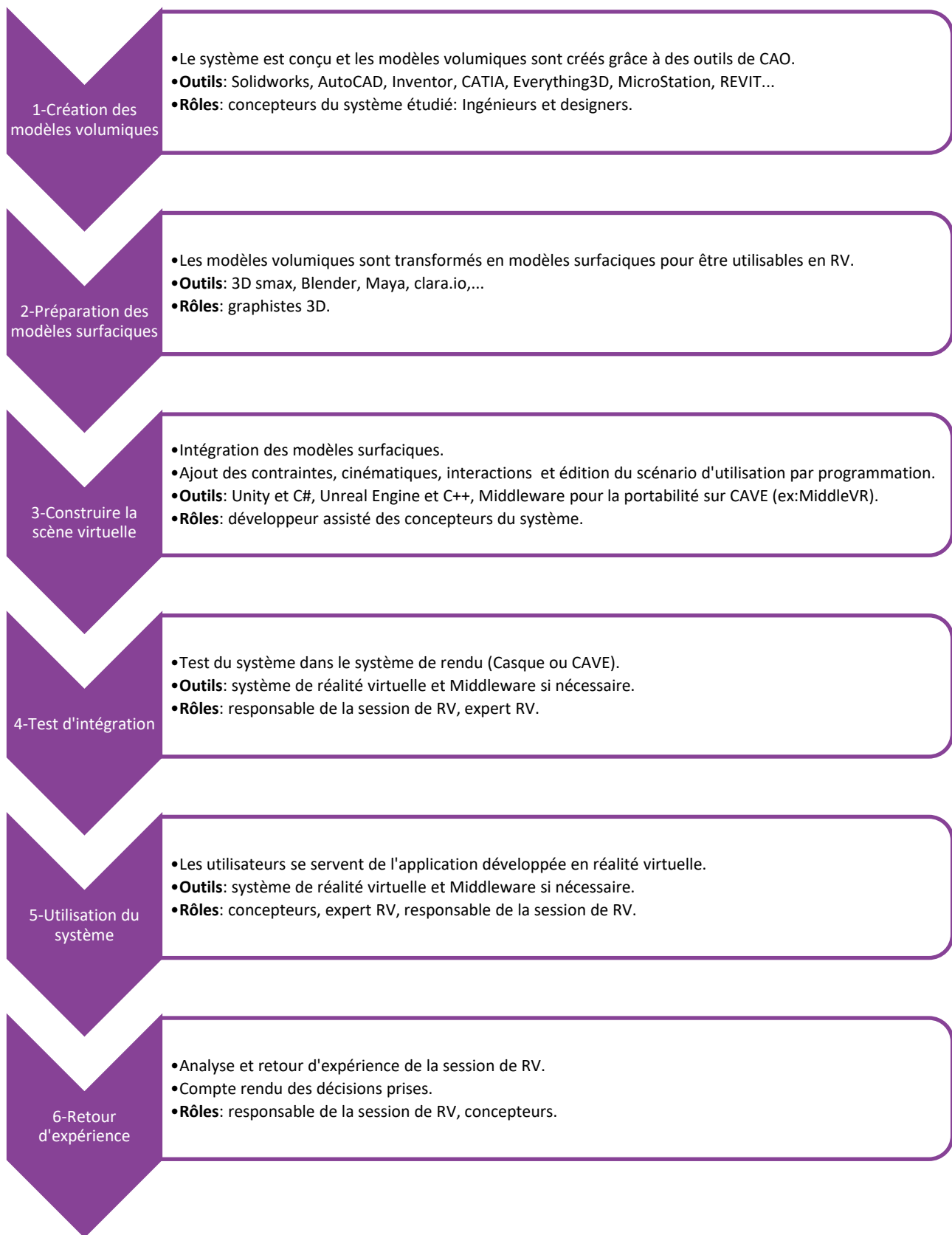
Figure 104: flux de travail permettant de créer une application de réalité virtuelle à usage industriel. Flux réalisé en s'inspirant des travaux de (Berg & Vance, 2017)
