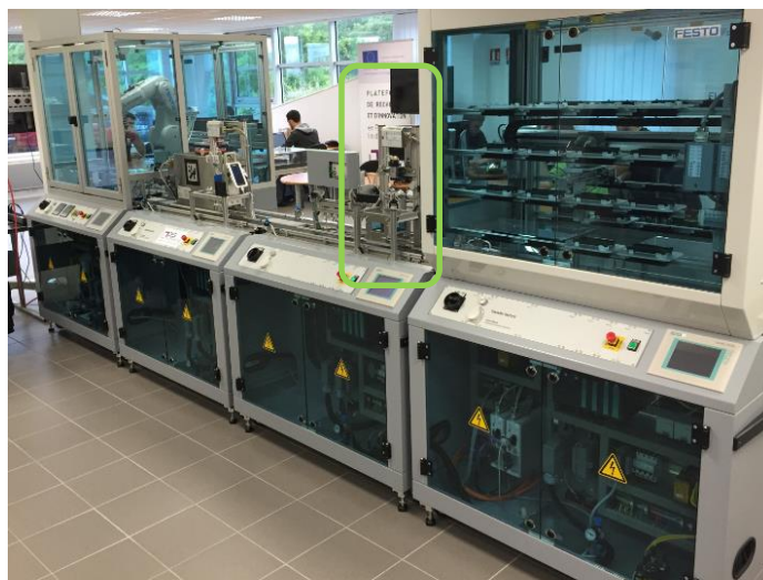
Figure 53: chaîne de production didactique sur laquelle l'opération de maintenance est effectuée. Le module de presse est encadré en vert.
