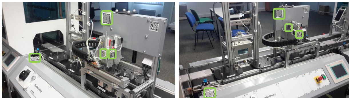
Figure 71: marqueurs placés sur le système pour permettre le suivi en réalité augmentée (encadré en vert). A gauche, les marqueurs 1, 2, 4 et 5 sont visibles, à droite les marqueurs 1, 2, 3, 5 sont visibles.
