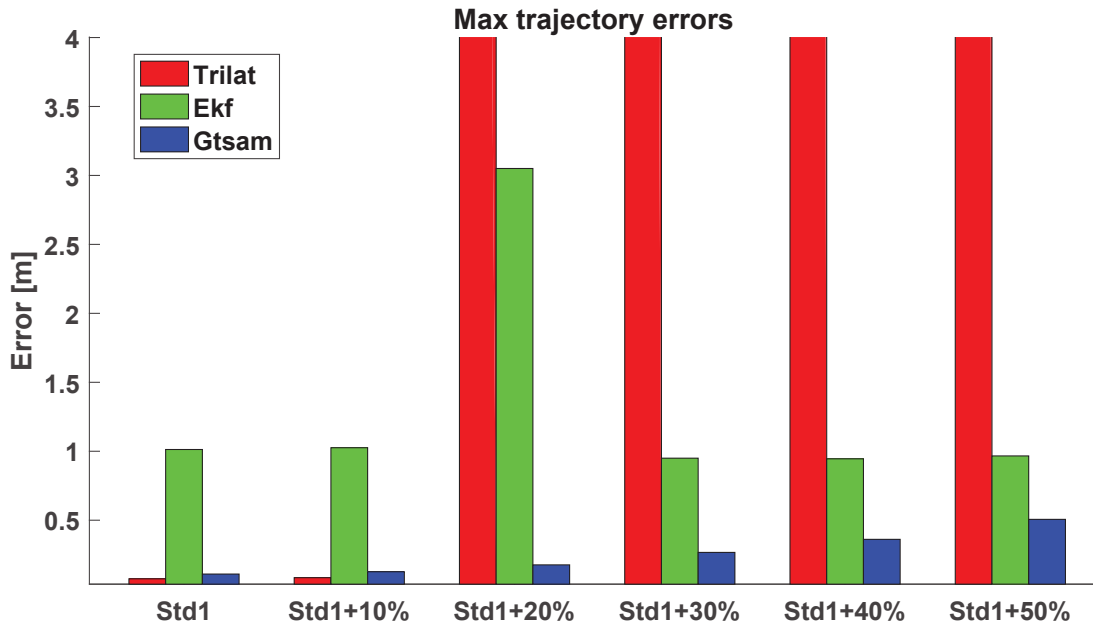
FIGURE 3.20 – Comparaison des erreurs de trajectoires maximales pour différents algorithmes de localisation et pour différents pourcentages de mesures erronées pour le jeu de données Gesling2
