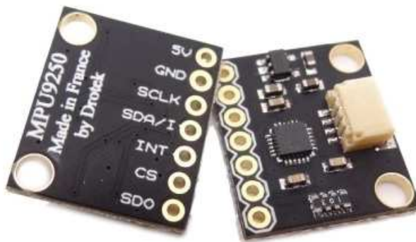
FIGURE 2.11 – Centrale inertielle MPU9250 de Invensense montée sur le robot. À noter les petites dimensions du module de l'ordre de 2 \times 2 cm et son faible coût d'une dizaine d'euros.
