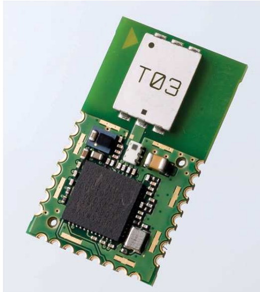
FIGURE 2.7 – Module DWM1000 de Decawave ( http://www.decawave.com ) utilisé pour obtenir les mesures de distance
