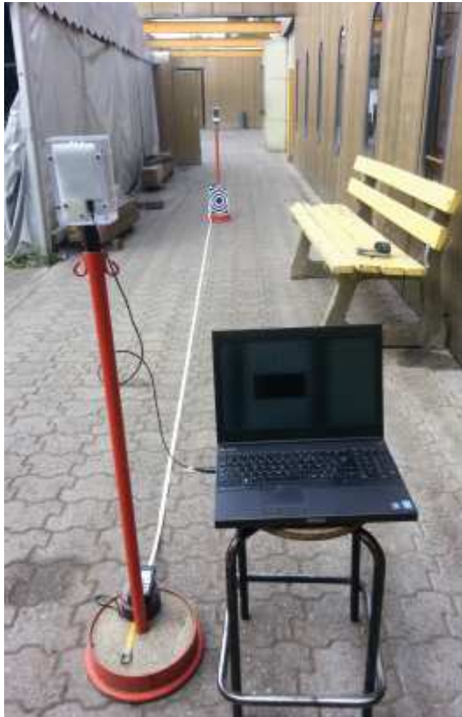
FIGURE A.8 – Dispositif de test du module DWM1000 avec boîtier. La réalisation des tests le long du couloir peut être la cause des difficultés rencontrées pour l'obtention de certaines mesures. Les murs de part et d'autre du couloir peuvent provoquer des réflexions des ondes qui vont alors perturber la mesure.
