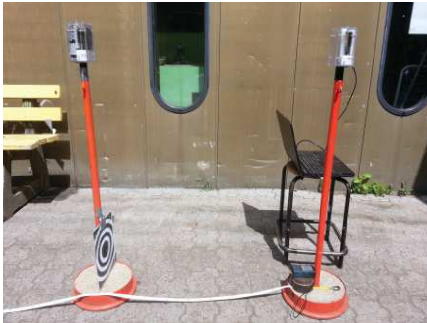
FIGURE A.7 – Dispositif de test du module DWM1000 avec boîtier. La cible au bas du poteau rouge gauche permet de mieux visualiser le point du laser posé au bas du poteau droit.
