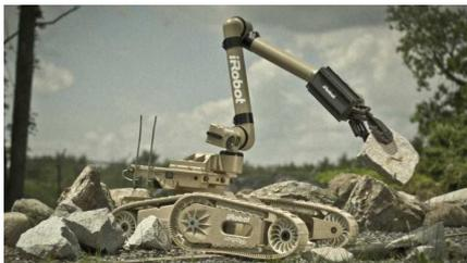
(c) Robot de déminage Kobra 710 d'iRobot
