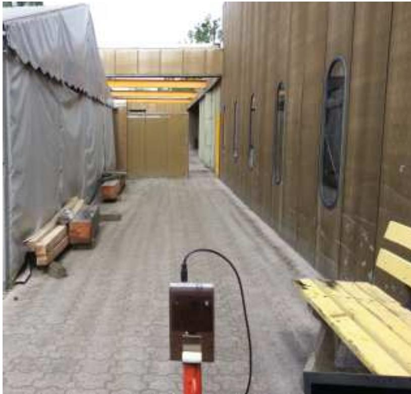
FIGURE A.6 – Dispositif de test du module DWM1000 sans boîtier avec une porte métallique comme obstacle au milieu des deux balises
