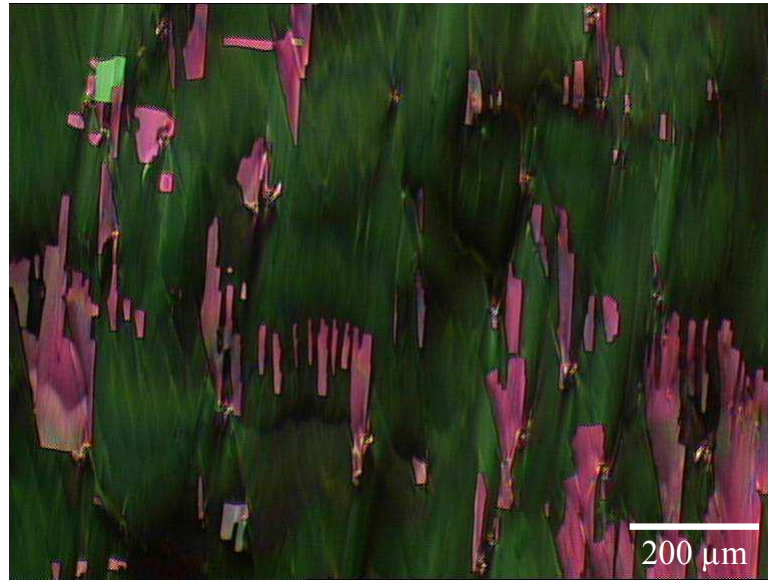
FIGURE 1.10 – Texture de la phase SmC^* en géométrie SSFLC prise au microscope optique entre polariseurs croisés montrant la coexistence des deux états stables.
