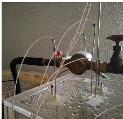
Figure 19 – Les capteurs de température insérés dans le bac 2.
