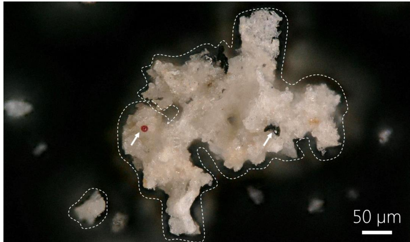
Figure 113 : Particules ablatées lors de l'irradiation laser d'une croûte épaisse ; pointillés blancs = agglomérats de cristaux de gypse ; flèche blanche = microparticules noires ou colorées (image MO).
