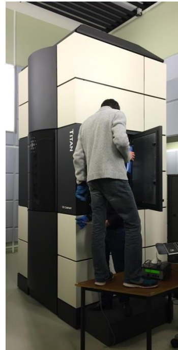
Figure 50 : Insertion d'une lame FIB dans le microscope Titan.
