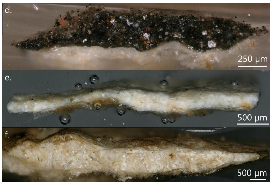
Figure 144 : Prélèvements vus de dessus provenant de a. zone non nettoyée ; b. zone ocre jaune nettoyée au laser ; c. zone beige clair nettoyée par nébulisation ; d., e., f. = vues en coupe de a., b., c. (images MO).
