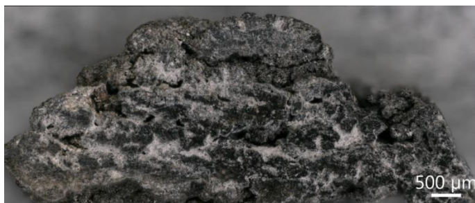
Figure 109 : Coupe transversale de la croûte noire naturelle provenant de la basilique Saint-Denis (image MO).
