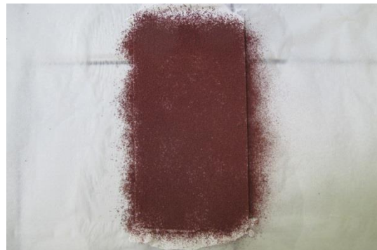
Après saupoudrage (ici croûte modèle à 30% d'hématite)
