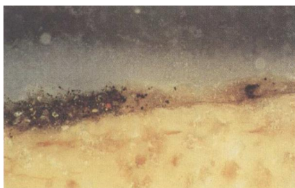
Figure 8 : Restes de croûte noire décolorée après nettoyage laser sur le portail Saint Jean de la cathédrale de Rouen (source : Oriol & Vergès-Belmin, 1995).
