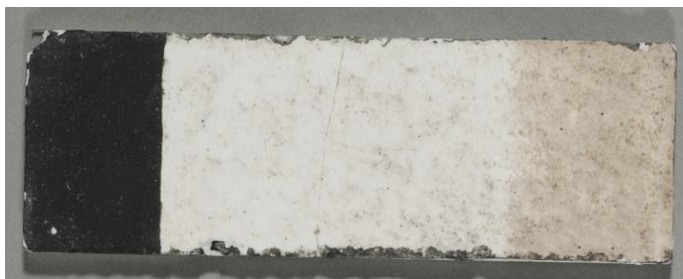
Figure 19 : Croûte noire modèle à base de noir de fumée sur plâtre; à gauche : non irradié, à droite : irradié au laser à 1064 nm, au milieu : irradié à 1064 nm puis exposé à la lumière UV ; (source : De Oliveira et al. , 2015).
