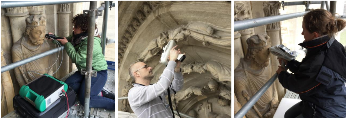
Figure 54 : Mesure de la réflexion avec un spectromètre portable.
