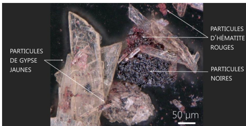
Figure 71 : Particules ablatées lors de l'irradiation laser de croûte modèle épaisse à 30% (image MO).
