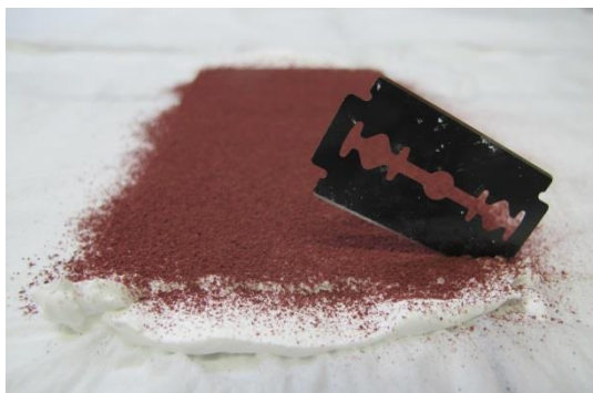
Séparation des éprouvettes à la lame de rasoir
