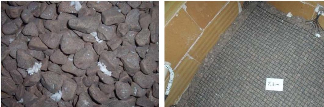
Fig. 90. Photographies de l'intérieur du régénérateur à graviers lors des travaux de démantèlement à l'issue de la campagne d'essais.
