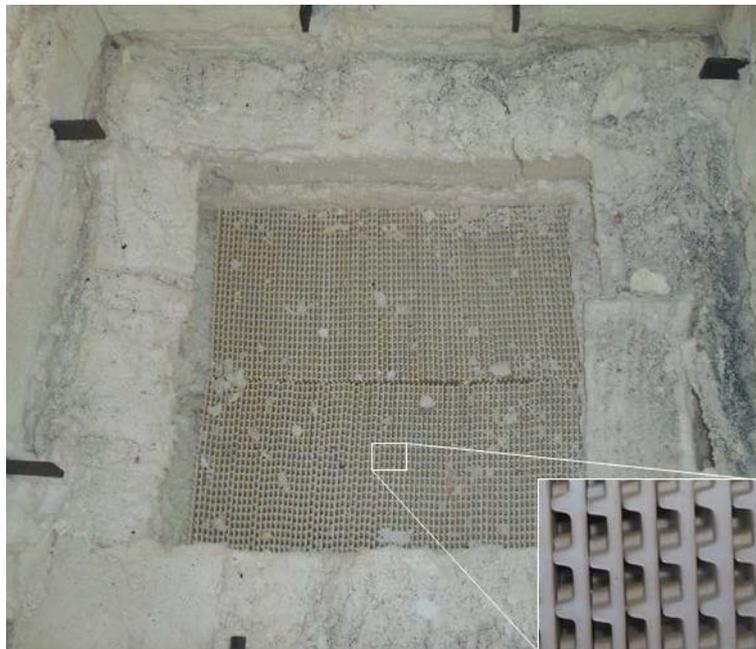
Fig. 75. Photographie de l'intérieur du régénérateur à plaques. Vue de dessus lors des travaux de démantèlement à l'issue de la campagne d'essais.
