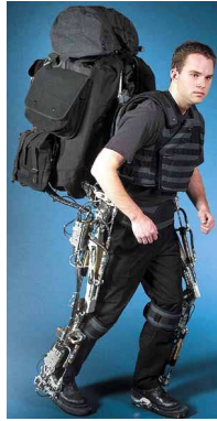
FIGURE 1.11 – BLEEPX (États-Unis) [25] - Avec une charge élevée sur le dos de l'exosquelette, l'utilisateur doit contre-balancer le poids du sac vers l'avant.
