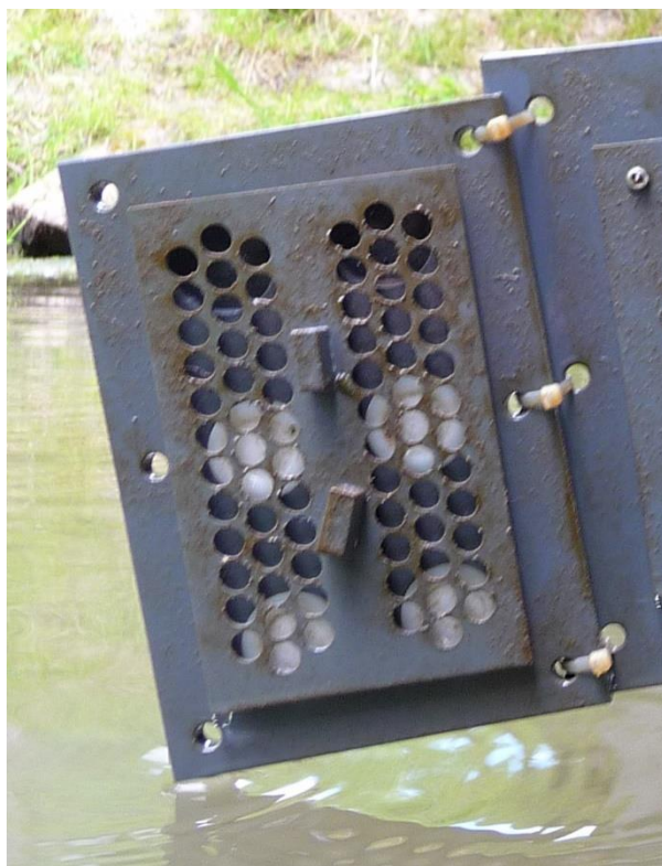
Annexe 2.1 : Photo de dispositifs utilisés par le GRESE lors de déploiements terrain d'échantillonneurs DGT
