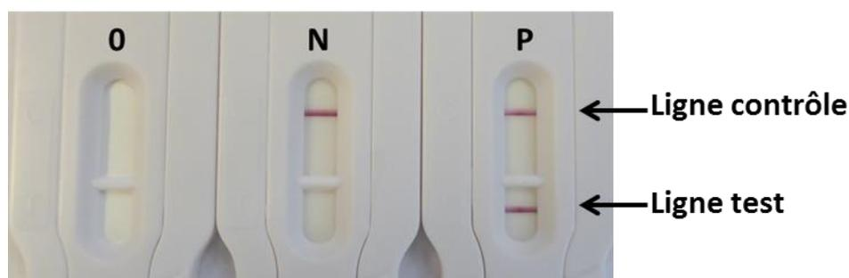
**Figure 41 : Illustration de cassettes commerciales « mono-test »**
