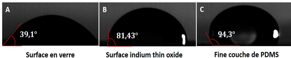
Figure 3.12 : Images d'angles de contact à l'eau des trois différentes surfaces : A) Substrat en verre, B) surface d'ITO, C) fine couche de PDMS
