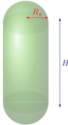
FIGURE D.2 – Particule cylindrique avec extrémités sphériques de hauteur  $H$  et de rayon  $R_s$ . Son rapport d'élongation  $R$  est donné par  $R = \frac{R_s}{R_s + H/2}$ .
