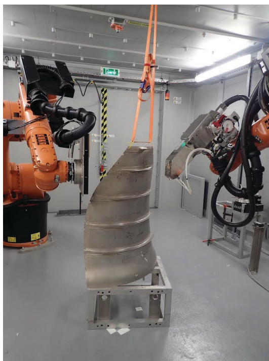
FIGURE 8.1: Cellule de tomographie X robotisée installée au CEA-LIST.
