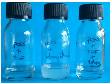
Figure VI-16: Solubilisation des POSS dans différents solvants. De gauche à droite, solubilisation dans du THF, solubilisation dans du butoxyéthanol et dans un mélange THF/Butoxyéthanol (50/50 en masse)
