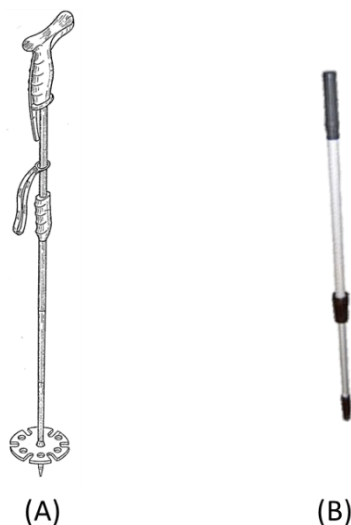
Figure 94 : Exemple de blocage par adhérence (A : bâton de ski ; B : bâton réglable de balai).
