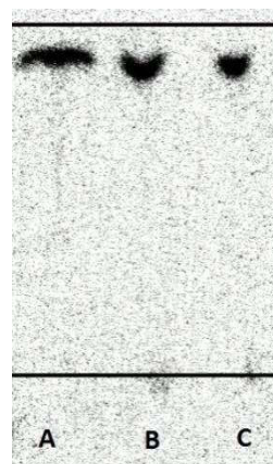
Figure 4.4. Représentation CCM (pH = 5,37, n_L/n_M = 2,5 ) L^3Cu . A = 60 min, B = 45 min, C = 15 min. Eluant : 25 % \text{NH}_3/\text{MeOH}/\text{H}_2\text{O}
