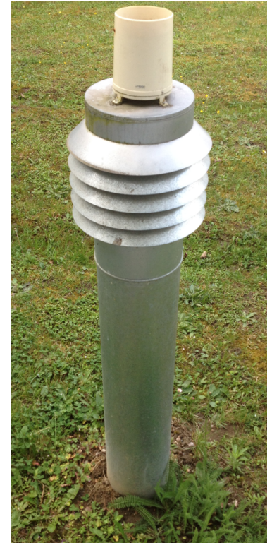
Figure 3.11 – Photo du pluviomètre.
