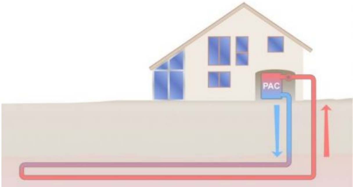
Figure 1.7 – Schéma de principe d'un captage horizontal.
