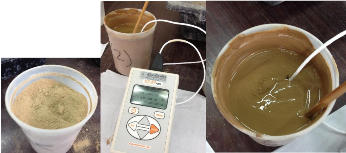
Figure 4.20 – Exemple de la caractérisation d'un échantillon. À gauche : argile à l'état sec. Au centre : appareil de mesure KD2Pro. À droite : argile saturé en eau.
