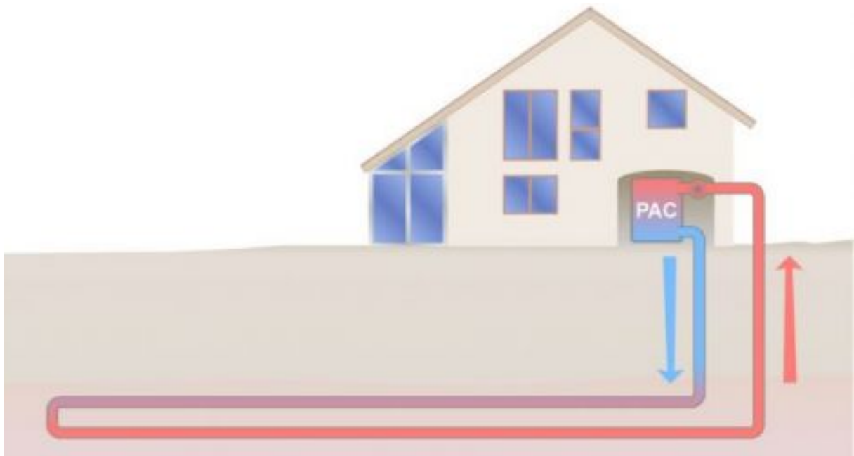
Figure 1.7 – Schéma de principe d'un captage horizontal.
