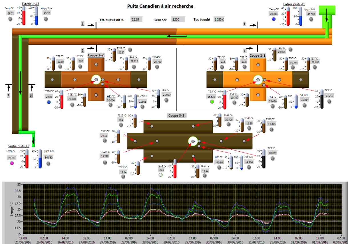
Figure 1.17 – Application développée sous LabVIEW pour l'enregistrement et la visualisation des données de mesures. Les pastilles de couleur grise indiquent la position des capteurs sur le site. Les pastilles à côté des baromètres permettent de visualiser la mesure sur le graphique en bas de l'image.
