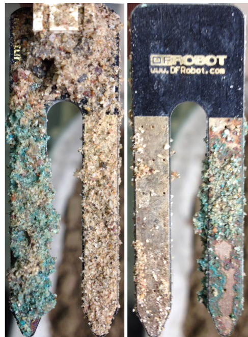
Figure 3.19 – Phénomène de corrosion du capteur SEN0114.
