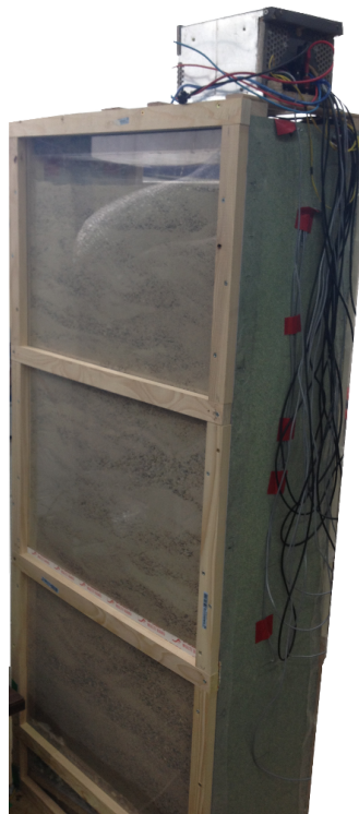
Figure 3.17 – Photo du dispositif expérimental avec un sol composé uniquement de sable 0-5 mm.
