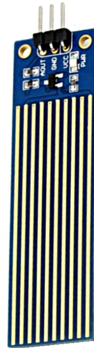
Figure 3.9 – Capteur de niveau d'eau.
