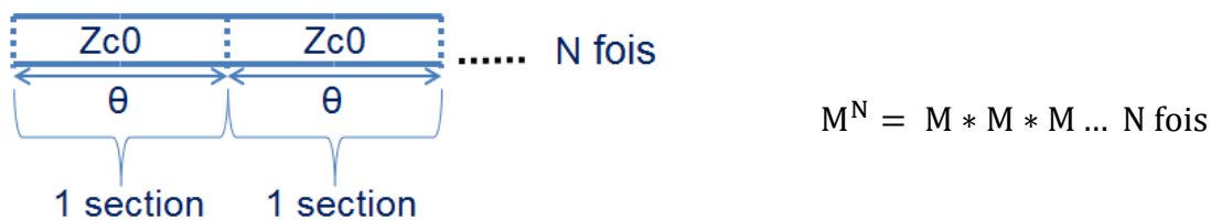
Figure 41: Schéma d'une ligne de transmission et de sa représentation matricielle à l'ordre N
