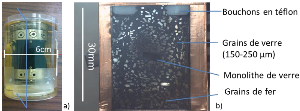
Figure 17 : photographies du système « MVE » avant découpe (en a) et après découpe selon l'axe bleu (en b)
