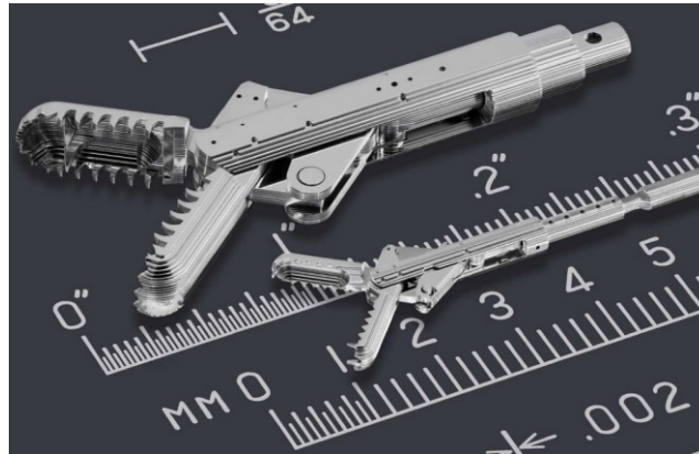
Figure I.45 : Pincettes réalisées avec la technique EFAB [43]
