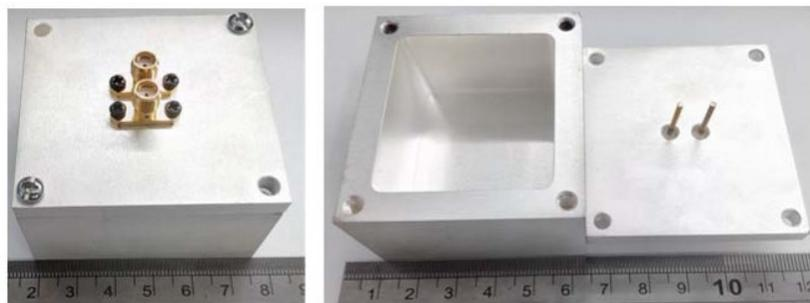
Figure III.4 : Filtre passe-bande d'ordre 3 à 5,5 GHz à cavités métalliques [82]
