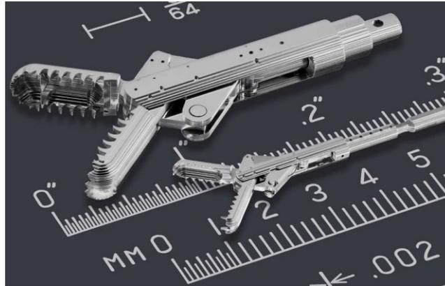
Figure I.45 : Pincettes réalisées avec la technique EFAB [43]
