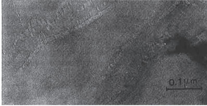
Figure I-32 : Micrographie MET de B<sub>4</sub>C irradié à 12,9x10<sup>21</sup>.cm<sup>-3</sup> en réacteur rapide ; l'hélium se place préférentiellement dans les inhomogénéités du matériau telles que macles, défauts d'empilement, dislocations [91].
