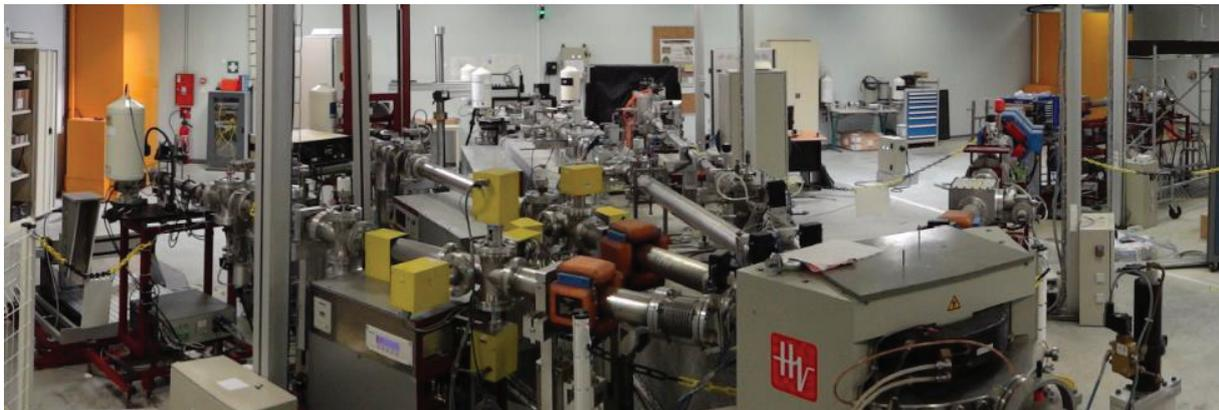
Figure II-8 : Plateforme AIFIRA, vue panoramique des 5 lignes de faisceaux distribuées par l’accélérateur Singletron et dissociées par l’aimant de commutation (au premier plan).
