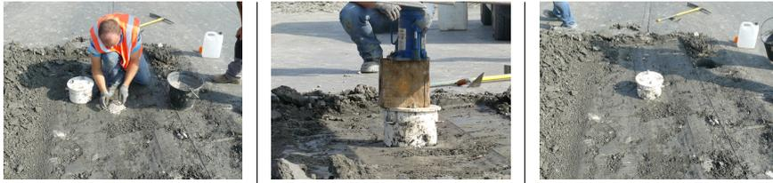
FIGURE 2.21 – Matériel de mesure de perméabilité
