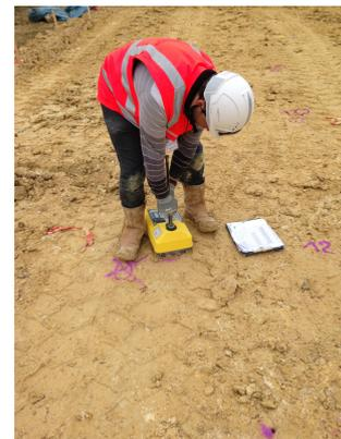
FIGURE 2.22 – Principe de la mesure au gammadensimètre
