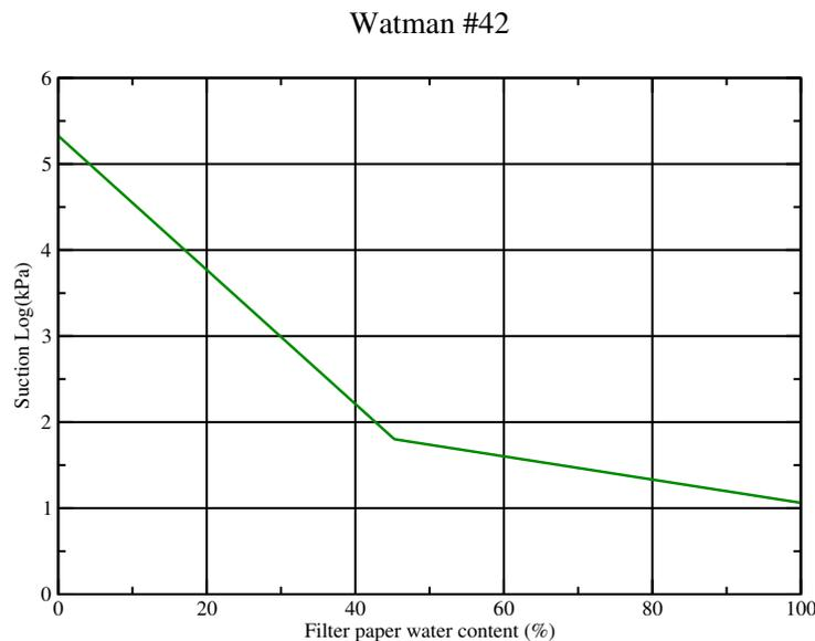
FIGURE 1.8 – Courbe de rétention proposée par la norme ASTM pour filtre Watman 42
