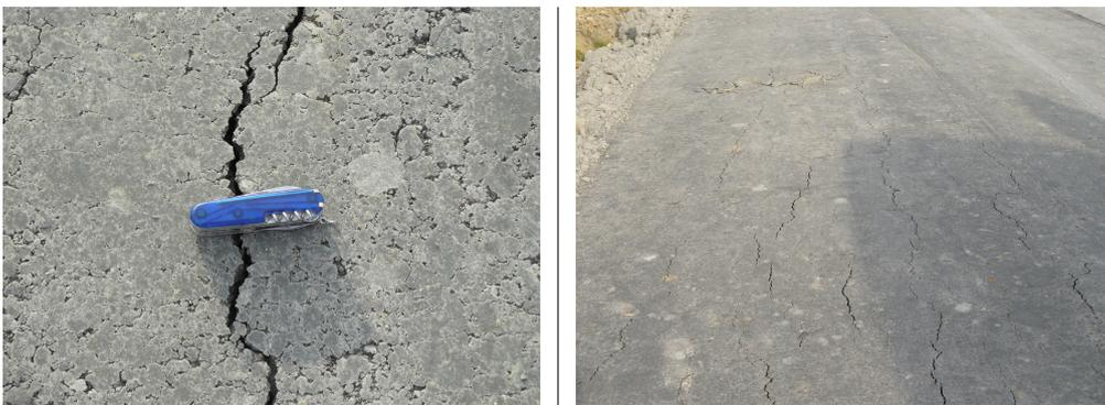
FIGURE 2.11 – Fissuration après dessiccation du plot 2BMV5
