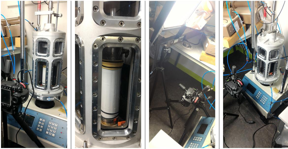
FIGURE 4.18 – Dispositif de prise d'image pour la cellule triaxiale (avec échantillon)
