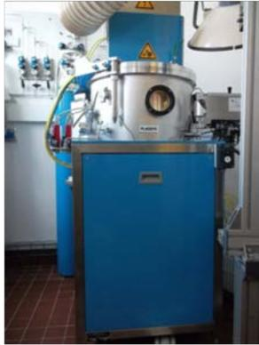
Figure II.3 – *Machine de dépôts Plassys*
