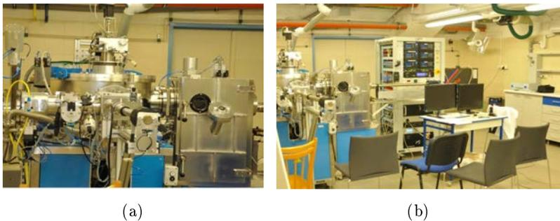
Figure II.4 – ?? et ?? *Cluster de dépôt incluant deux chambres et sas de chargement pour PLD, évaporation par effet Joule et canon à électron, RF magnétron pulvérisation et co-pulvérisation (Université de Pardubice, République tchèque).*
