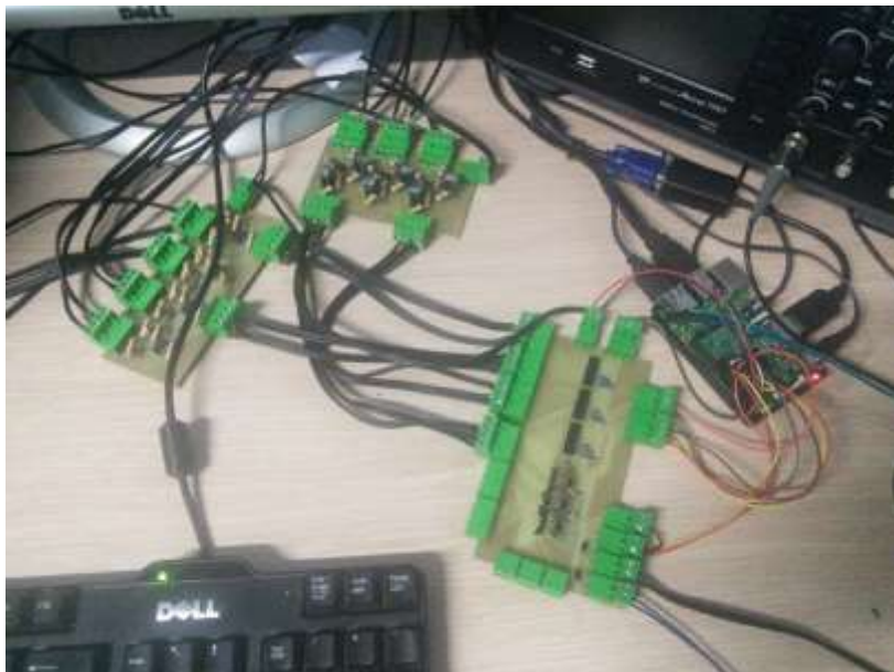
Figure 49 - StoveMAS installé sur la Raspberry Pi avec les cartes d'acquisition au laboratoire Lab-STICC.
