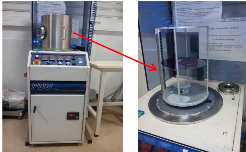
Figure 58. Photo du bâti de dépôt de Parylène avec une vue de l'intérieur de la cloche montrant le porte-substrat [133].
