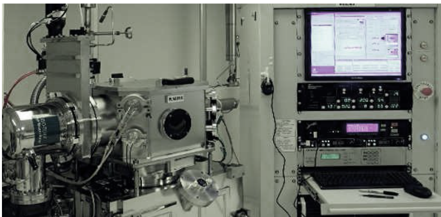
Figure 57. Photo de l'évaporateur Plassys 550S du BCAi utilisé pour le dépôt des électrodes.
