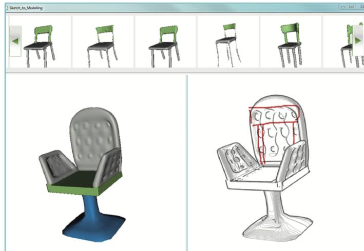
FIGURE 2.8 – Capture d'écran de l'interface de modélisation par esquisse 2D, extrait de Sketch to Design [87]. Le modèle est visible sur la gauche. Sur la droite, l'utilisateur dessine par dessus un segment, et les candidats pour le remplacement sont présentés dans la galerie dans la partie supérieure de l'interface.
