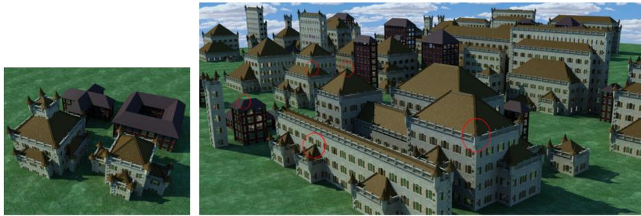
FIGURE 2.4 – Exemple de synthèse de modèles à partir d'exemple, extrait de Merrell *et al* [56]. À partir d'un ensemble de modèles (à gauche), de nouveaux modèles sont générés (à droite). Les sommets entourés en rouges définissent des contraintes de connectivité (ici, ils doivent être à l'intersection de 4 faces).
