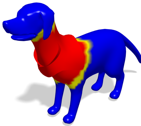
FIGURE 5.4 – Illustration des zones de jonction. Les deux régions de jonction sont représentées en rouge. Les sommets rouges et jaunes sont déplacés par le recalage semi-rigide. Les sommets en bleu sont déplacés par une transformation rigide à chaque itération.
