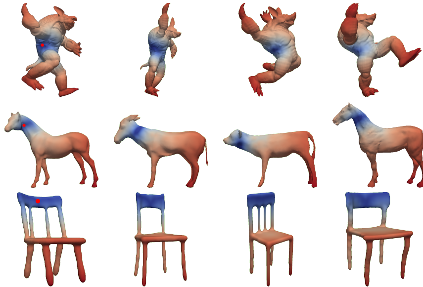
FIGURE 3.7 – Correspondance entre plusieurs modèles, calculé à partir de notre descripteur. Pour chaque classe (Armadillo, FourLeg and Chair), nous calculons la distance L_2 entre le descripteur du point rouge à chaque sommet de chaque modèle de la classe (illustré dans une échelle logarithmique allant du bleu au rouge). La similarité sémantique entre les régions bleues de chaque ligne illustre l'obtention d'une correspondance entre ces modèles.
