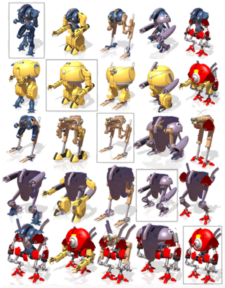
FIGURE 2.6 – Résultats de mélanges entre deux modèles, extrait de Jain et al. [32]. Les modèles présents sur la diagonales sont les modèles originaux, tandis que ceux présentés sur l'anti-diagonale correspondent à un mélange avec un poids de 0.5.
