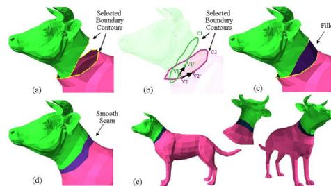
FIGURE 5.1 – Création d'une jonction entre deux surfaces par ajout de géométrie, extrait des travaux de Funkhouser *et al.* [26] - (a) Sélection des contours - (b) Sélection des deux points les plus proches  $V_1$  et  $V_2$  et orientation des contours - (c) Ajout de géométrie entre les sommets correspondants - (d) Lissage local (e) Résultat final.
