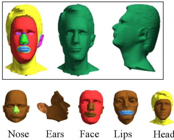
FIGURE 2.5 – Illustration de la méthode de Funkhouser [26]. En haut : visage obtenu par assemblage de parties ; chaque partie est colorée différemment. En bas : les modèles retrouvés dans la base de visages, dont les parties ont été sélectionnées par l'utilisateur.
