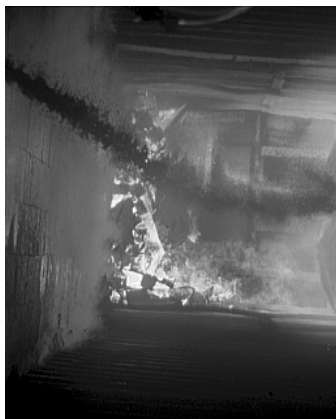
FIGURE 1.6: Exemple d'utilisation de l'imagerie SWIR pour les opérations anti-incendies. Les flammes sont visibles à travers la fumée.
