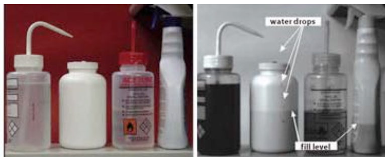
FIGURE 1.9: Comparaison imagerie visible/SWIR de contenant de liquide. A gauche l'image visible, à droite l'image SWIR avec le niveau de remplissage est apparent.
