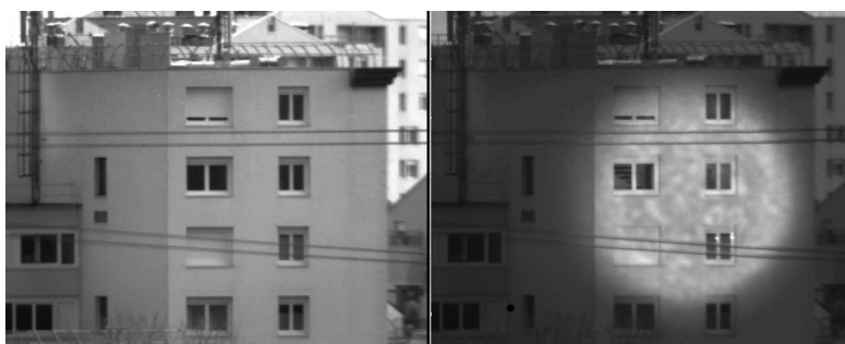
FIGURE 1.7: Façade d'un immeuble éclairée par un laser 1550 nm pour imagerie active SWIR. A gauche l'image en visible, à droite en SWIR avec éclairage localisé SWIR.
