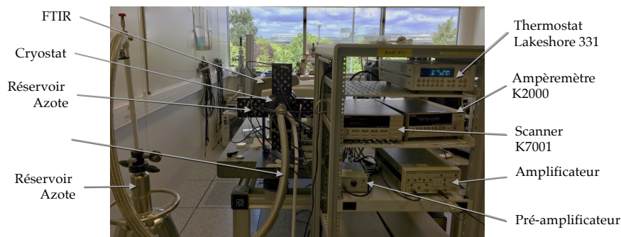
FIGURE 3.16: Photographie du montage permettant les caractérisation opto-électroniques des photodiodes.
