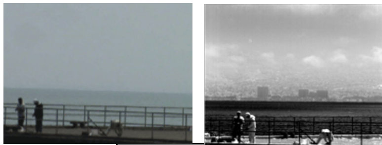
FIGURE 1.5: Comparaison imagerie visible/SWIR d'une scène avec brouillard. L'image SWIR (à droite) permet la vision à travers le brouillard et révèle le fond de la scène.
