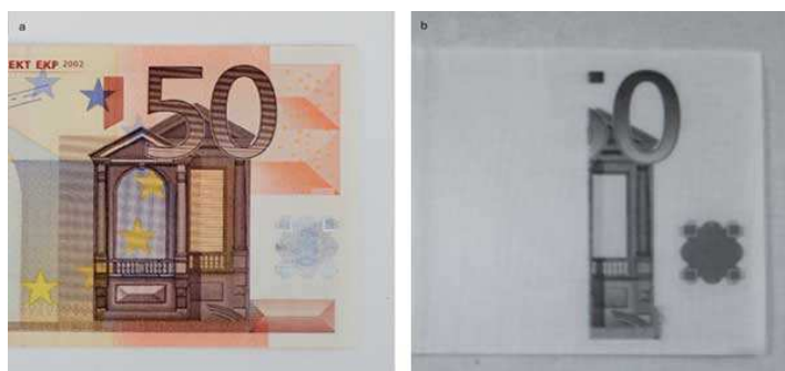
FIGURE 1.11: Comparaison d'un billet de banque en imagerie visible et SWIR. On remarque qu'une partie du billet est blanche en SWIR. D'après [28]
