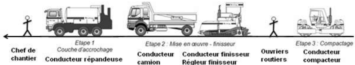
Figure 8 : Mise en œuvre d'un enrobé à chaud (Anses, 2013)
