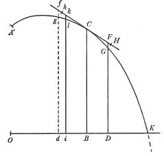
quadratum temporis conjunctim, adeog (ob datam gravitatem) ut quadratum temporis; & lineola HF ut resistentia & quadratum temporis, hoc est ut resistentia & lineola FG. Et inde resistentia fit ut HF directe & FG inverse, sive ut  $\frac{HF}{FG}$ . Hæc ita se habent in lineolis nascentibus. Nam in lineolis finitæ magnitudinis hæ rationes non sunt accuratæ.
