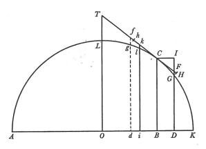
actionibus describerent: & a punctis C, G, g ad planum horizontale AK demittantur perpendicula CB, GD, gd, quorum GD ac gd tangenti occurrant in F & f. Per Medii resistentiam fit ut corpus progrediens vice longitudinis CH describat solummodo longitudinem CF; & per vim gravitatis transfertur corpus de F in G: adeog lineola HF vi resistentiæ, & lineola FG vi gravitatis simul generantur. (6) Proinde (per Lem. X. Lib. I. (7)) lineola FG est ut vis gravitatis &
