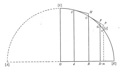
Jam ob tempora æqualia æquales sunt lineolæ CH, GF a gravitate<sup>(7)</sup> genitæ. Si nulla esset resistentia, corpus in fine temporis reperiretur in n. Per resistentiam fit ut corpus reperiatur in  $G_{(1)}$  ideog lineola  $[q]G^{(8)}$  vel pF per resistentiam generatur estg resistentia ad gravitatem ut Fp ad  $FG^{(9)}$  id est ut  $\frac{Dm \times gH^{(10)}}{dB}$  ad
