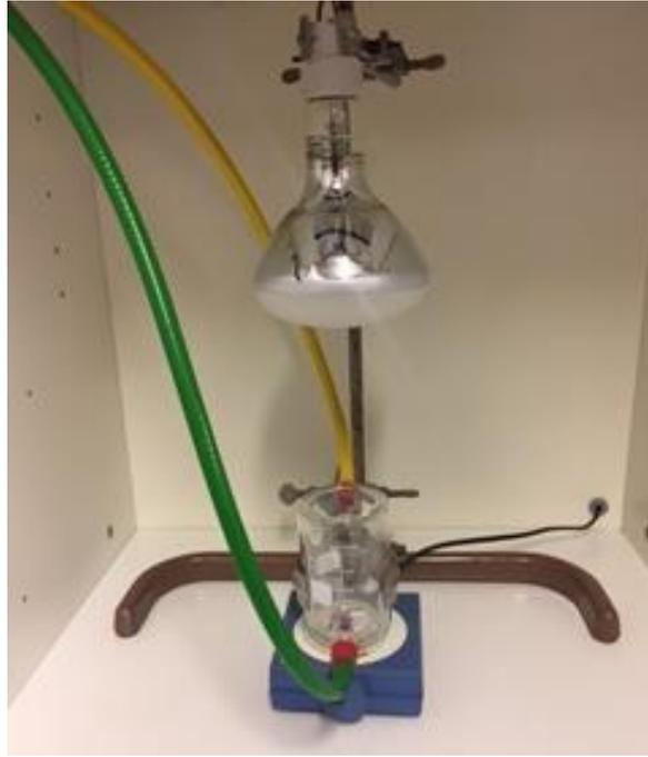
**Figure. 10 :** Réacteur photocatalytique à lampe 365 nm.
