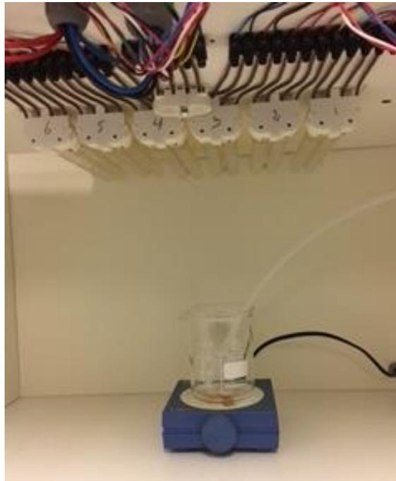
**Figure. 9 :** Réacteur photocatalytique à six lampes UV (6 x 18 W).
