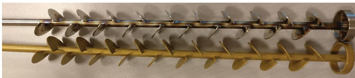
*Figure III.7 : Photographie de l'insert sans et avec le revêtement céramique*
