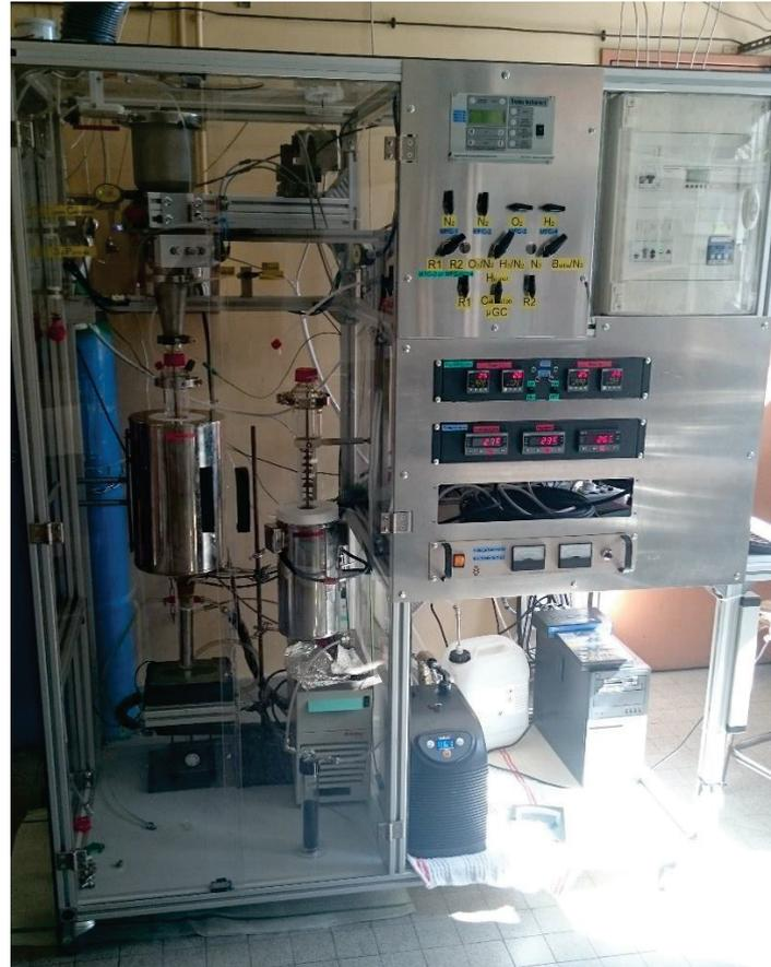
Figure III.10 : Photographie du banc de test de pyrolyse
