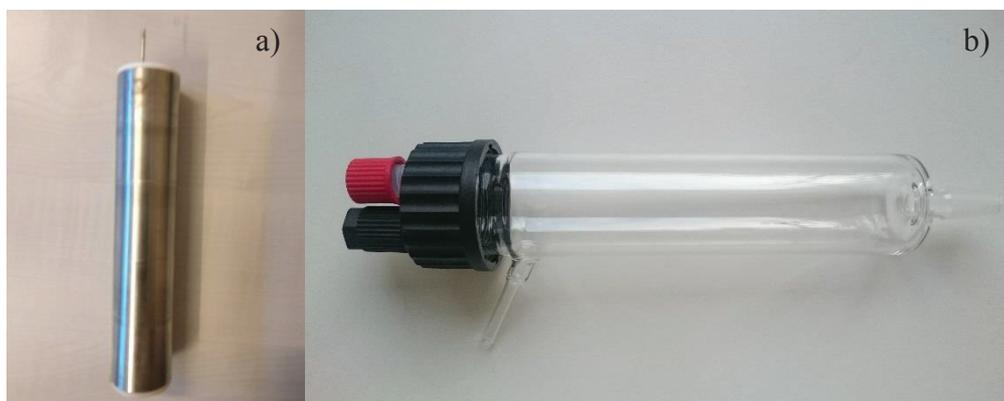
Figure III.8 : Photographies de a) l'anode et b) la verrerie du piège électrostatique
