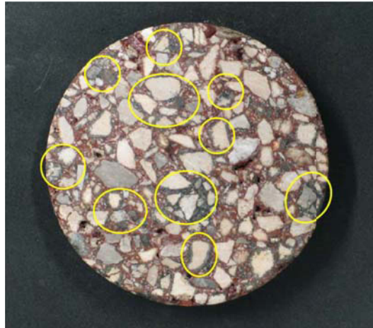
FIGURE 1.19 – Éprouvette après 8 min de malaxage, les amas d'agrégats non mélangé avec le reste du mélange sont visibles.
