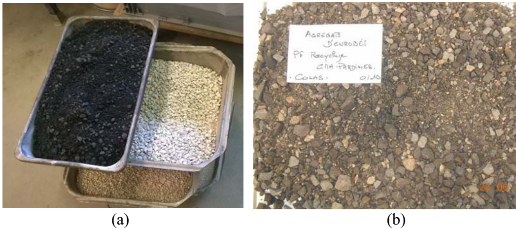
FIGURE 3.1 – (a) Agrégats d'enrobé (noir) et les granulats d'apport (blanc), (b) les granulats d'agrégats d'enrobé dépourvus de leur enrobage.
