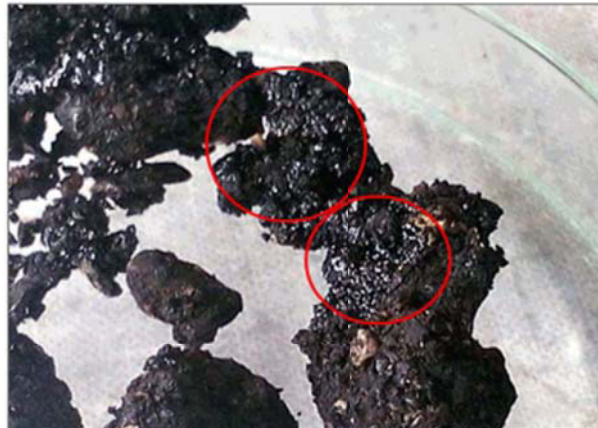
FIGURE 1.26 – Exemple de la réactivation d'une couche de LAE au cours du mélange avec les GA [72].
